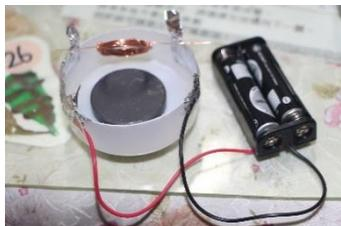
完成可轉動的馬達後，請學生依電流磁效應的模型畫圖解釋線圈馬達的轉動原理，上臺發表。
